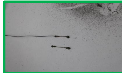
У каждой половинки иголки оба полюса
