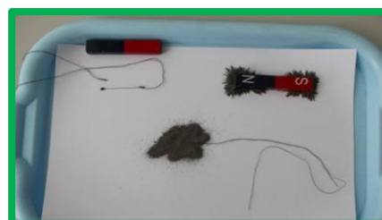
У магнита два полюса: северный и южный
