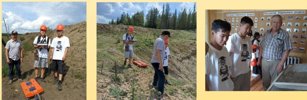
Для исследования глубины залегания угольного пласта использовали георадар «ОКО-2» с антенным блоком АБ-250 МГц. Глубина залегания угольного пласта Кировского разреза составила от 3 до 4 м.
