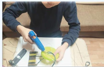
Для герметичной склейки деталей используем горячий пистолет
