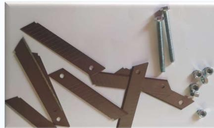
Пластины изготавливаем из нержавеющей стали. Использованы лезвия из канцелярского ножа
