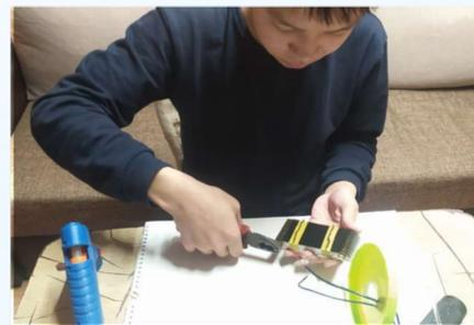
Соединяем пластины с помощью болта М 8 с гайкой.
