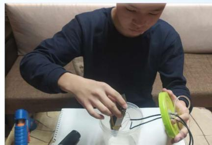
Ячейку электролизера делаем из герметичной пластмассовой тары емкостью 500 ml
