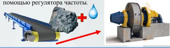
Входные параметры: - подача руды в мельницу,  $Q_P$ , т/ч; - расход воды в мельницу,  $Q_B$ , м<sup>3</sup>/ч;
