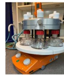
Процесс экстракции антоцианов в реакционной станции Carousel 6 Plus
