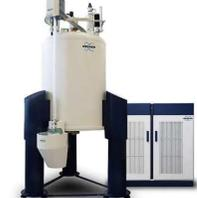
ЯМР-спектрометр высокого разрешения Avance III 400 МГц (Bruker)
